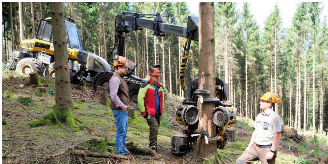
Einzigste Chance, die Borkenkäferplage einzudämmen: die befallenen und toten Bäume möglichst schnell absägen und aus dem Wald transportieren. Mit dem Harvester geht das am schnellsten, Lohnunternehmer Marc Koppelberg (Mitte) schafft rund 50 Bäume pro Stunde.
