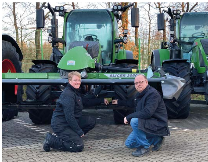
Fit in Tier- und Technikfragen: Tierexpertin Dr. Sandra Köhnke (links) informiert sich bei RWZ-Maschinenfachberater Frank Schneider (rechts) über die Vorteile des Fendt Slicer FQ, der mittels verschiebbarer Mäheinheit und 3-D-Bodenanpassung auch am Hang ein sauberes Schnittbild erzielt.
